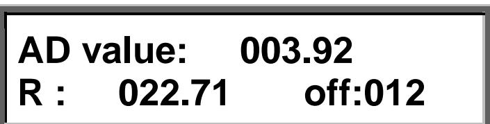
AD value: izmjereni iznos izlazne struje izmjenjivača, u amperima
